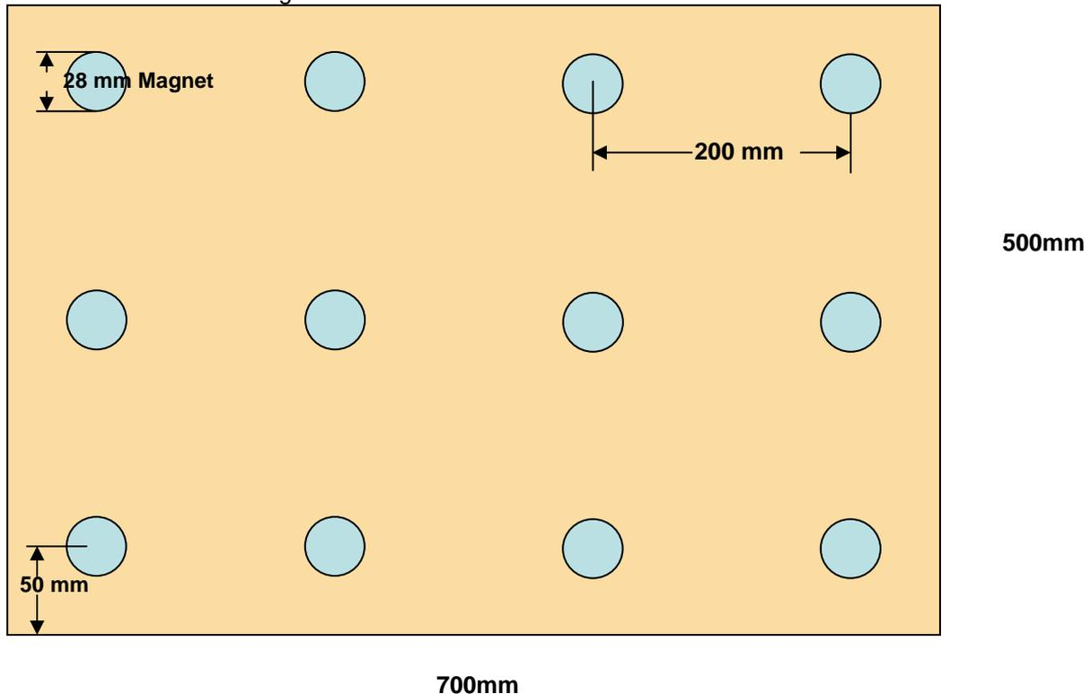
**Beschreibung:** VDE geprüftes, bis 1kV isolierendes Abdecktuch mit spannungsfest aufgeklebten Magneten zur individuellen Isolierung von spannungsführenden Teilen bei Arbeiten unter Spannung (ohne zusätzliche Verwendung von Klammern oder Klebeband)
