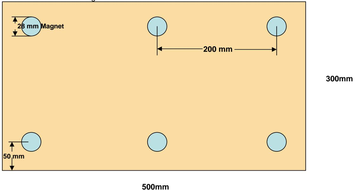
**Beschreibung:** VDE geprüftes, bis 1kV isolierendes Abdecktuch mit spannungsfest aufgeklebten Magneten zur individuellen Isolierung von spannungsführenden Teilen bei Arbeiten unter Spannung (ohne zusätzliche Verwendung von Klammern oder Klebeband)
